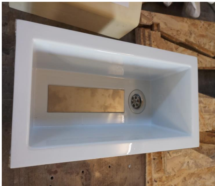
Fig. 8. Montarea benzii de inox
