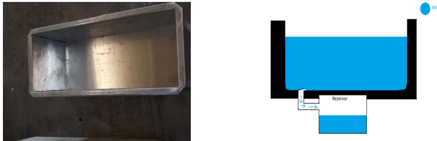
Fig. 13. Rezervorul metalic de stocare apă caldă evacuată
